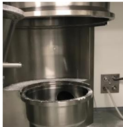
Figura 35- Zona de fecho da estufa onde está a borracha vedante
