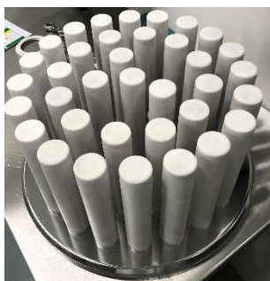
Figura 36- Filtros do frewitt granulado seco, visto de cima
