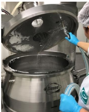
Figura 15- Lavagem manual do granulador
