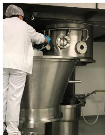
Figura 14- Lavagem manual da estufa de leito fluido
