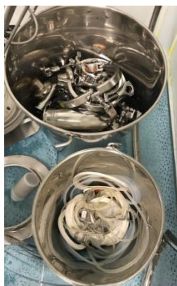
Figura 21 - Arrumação dos clampes e borrachas vedantes após lavagem
