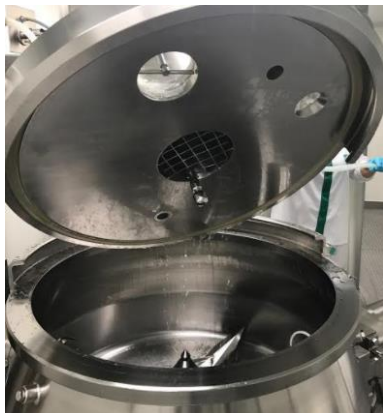
Figura 34- Zona de fecho do granulador onde está a borracha vedante
