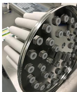
Figura 37- Filtros do frewitt granulado seco, visto lateralmente
